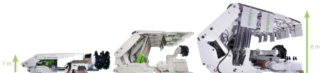
Obudowy ścianowe wraz z kombajnami produkcji Grupy FAMUR
