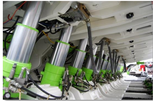
Zmechanizowana obudowa ścianowa FAZOS 10/19-2x2340
