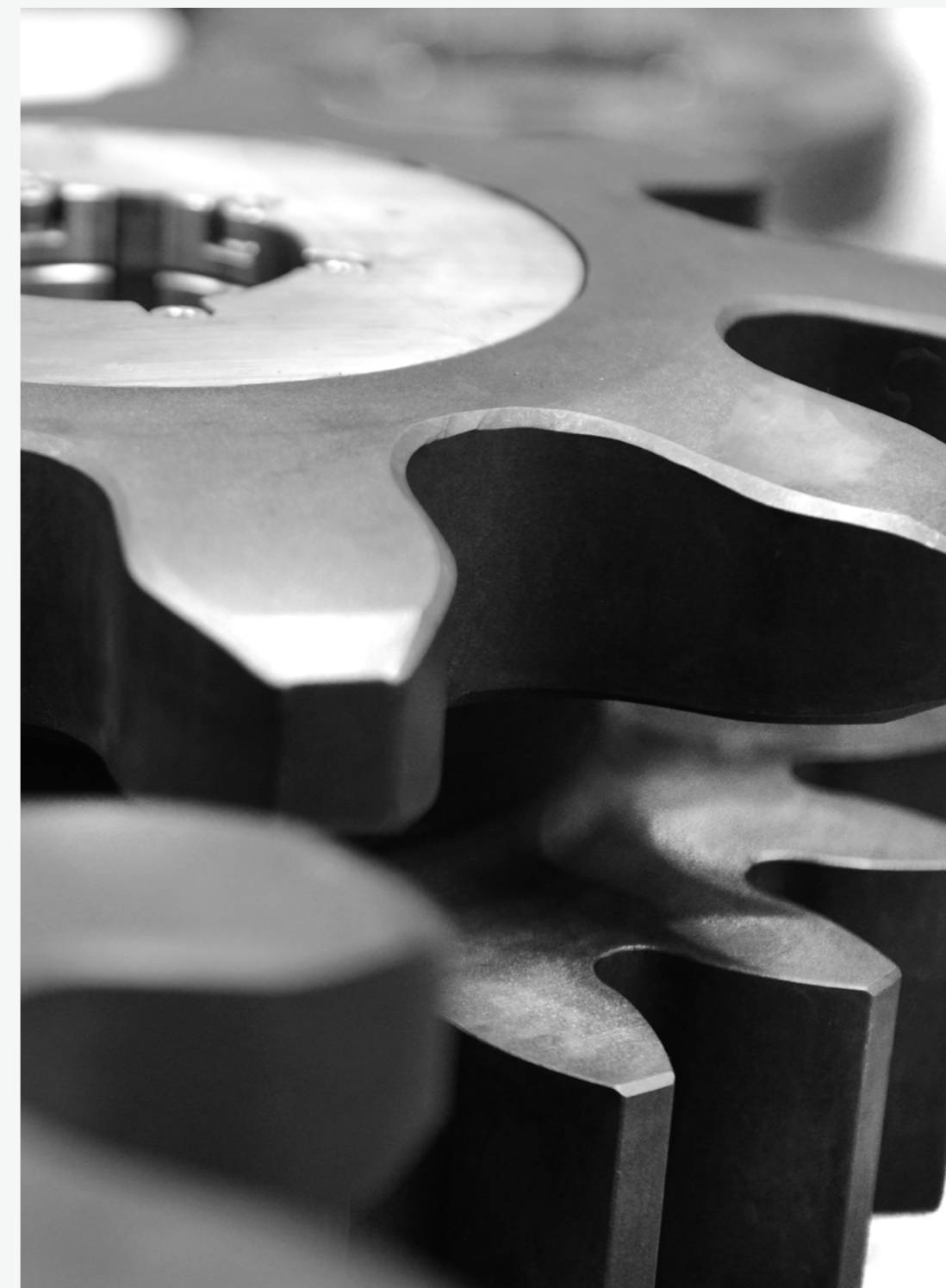
➤ Kombajnowe koła napędowe bezciągnowego systemu posuwu
